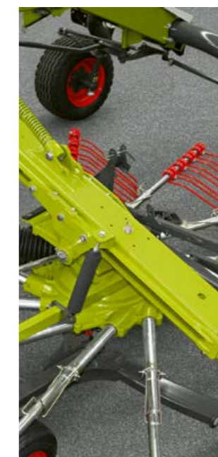
Přestavení mezi ukládáním do jednoho a dvou řádků.
