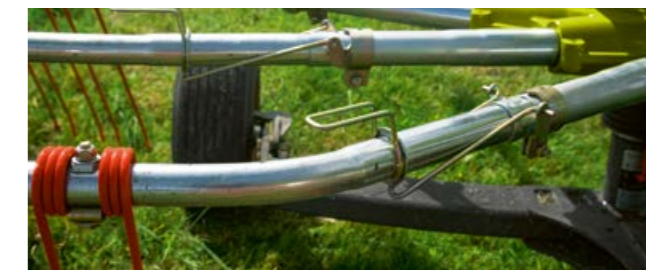
Ochrana v případě kolize: Ramena se kontrolovaně ohnou v definovaném místě.
