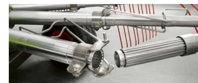
Patentované mazání ramen prstů PROFIX s drážkováním: pohodlná montáž a demontáž ramen prstů.
