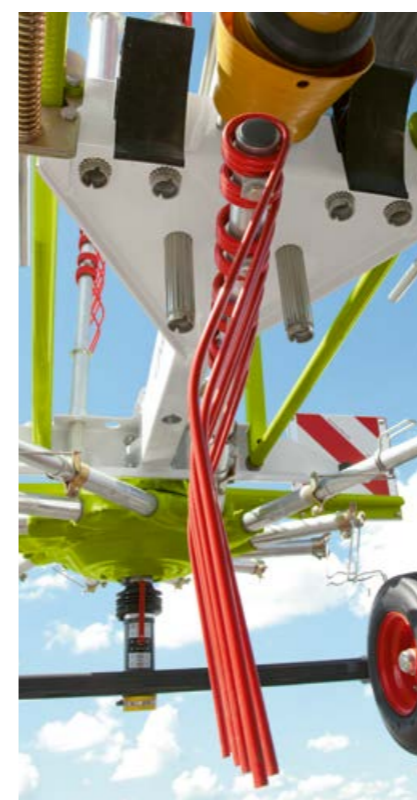
Standardní prsty u modelů 450, 420, 370 a 320 jsou se svými 9 mm extrémně stabilní a jsou vhodné jak pro seno, tak i pro senáž.
