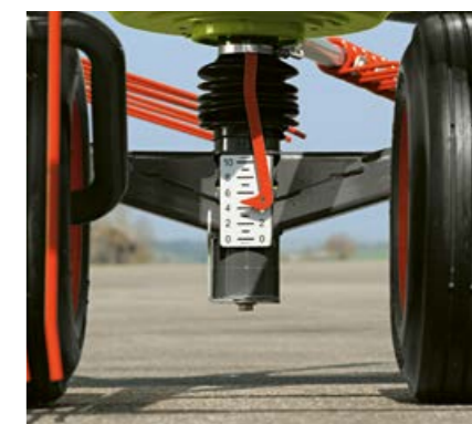
Stupnice pro nastavení výšky shrnování.
