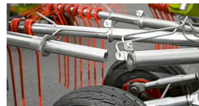
Spojení profilem citron a zajištění ramen prstů PROFIX u modelu LINER 700.
