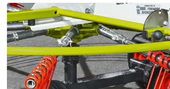
Spojení profilem citron a upínací závlačky u modelu LINER 370 a 320.
