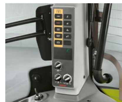
Počet otáček vývodového hřídele a elektronická regulace zvedacího závěsu jsou nastavitelné na B-sloupku.
