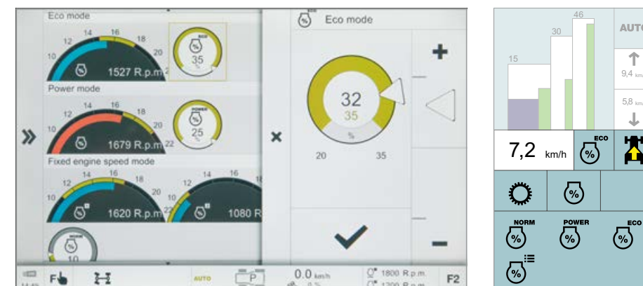
Nastavení dodávky paliva pro „Eco“ a „Power“, i pro paměť otáček motoru.
