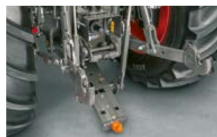
Alternativou k závěsnému nosiči je k dispozici připojení pomocí agroháku.
