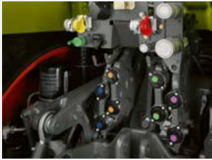
Vzduchová brzdová soustava s vysoušečem vzduchu.
