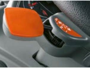
K dispozici řadicí páka pro změnu směru jízdy REVERSHIFT s elektronickou parkovací brzdou.
