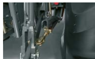
Automatické stabilizátory dolních táhel.
