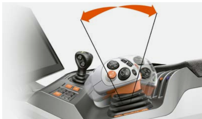
Progresivní ovládání díky technologii plynulé převodovky CMATIC.
