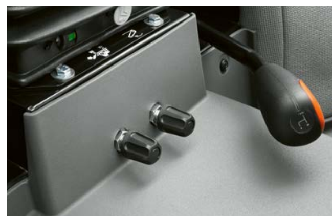
Také u mechanického zadního zvedacího závěsu lze nastavit v jemných stupních rychlost spouštění a citlivost regulace tažné síly pod sedadlem řidiče.
