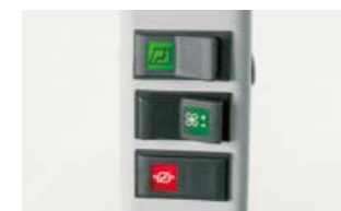
Údaje o stavu systému kabinového filtru a také aktivace a regulace ventilátorů v pohodlném dosahu na sloupku E.
