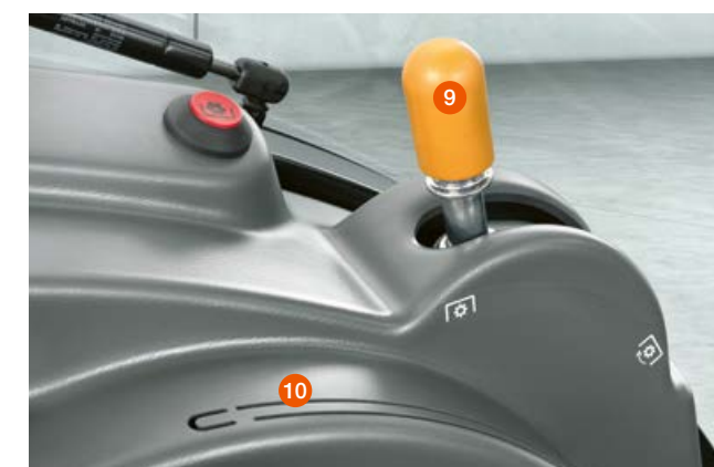
Vývodový hřídel je sériově hydraulicky připojen. U strojů s reverzací směru jízdy REVERSHIFT a vybavením TWINSHIFT je elektronické spouštění vývodového hřídele volitelně dostupné.
