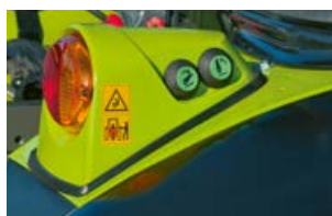
Komfortní externí ovládání u mechanicky nebo elektronicky ovládaného zadního zvedacího závěsu.
