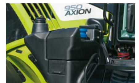
640 l palivová nádrž s integrovanou nádrží na močovinu o objemu 56 l
