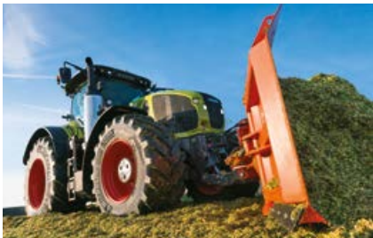
Ve spojení s čelním zvedacím závěsem jsou k dostání až dva dvojitelné hydraulické rozvaděče a jedna volná zpátečka na čelní závěs. Ideální pro zásobník osiva nebo shrnovací radlici v čelním připojení.
