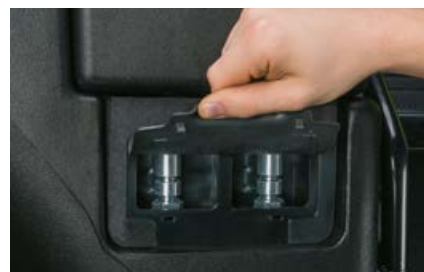
Externí připojení baterie je dostupné přímo na levé straně vstupu do stroje.
