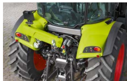
Snadná přístupnost vzduchového filtru kabiny za kabinou.
