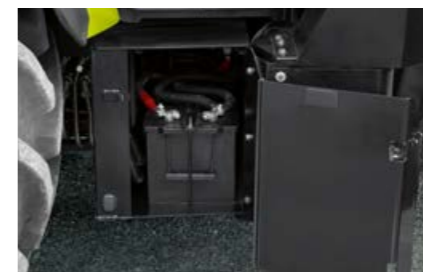
V pravé části schodků se nacházejí baterie a skříňka pro nářadí. Obojí je dobře přístupné.
