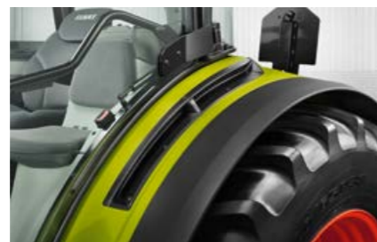
Díky bočnímu sání vzduchu do kabiny v zadních blatnicích je nasáván vzduch bez prachu, čímž dochází k prodloužení intervalů k údržbě filtru.
