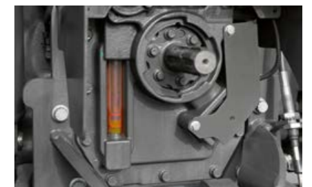
Jednoduchá kontrola stavu oleje převodovky a hydrauliky v průzoru vedle vývodového hřídele.
