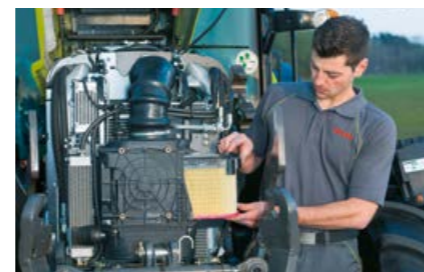
Jednoduché vyjmutí filtru motoru před chladiči.
