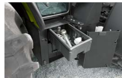
V pravé části schodků se nacházejí baterie a skříňka pro nářadí. Obojí je dobře přístupné.
