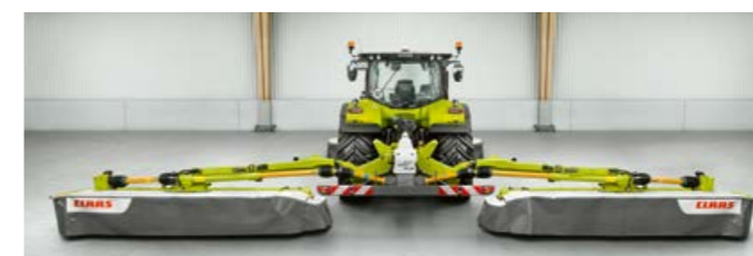
Dvě hydraulicky ovladatelná teleskopická ramena s plynulým nastavením pro optimální překryvání u modelu DISCO 1100 TREND.
