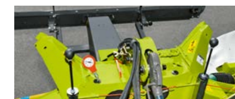
Manometr ke snadnému nastavení tlaku na povrch pole pro obě žací jednotky.
