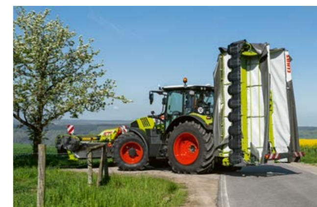
S výškou pod 4 m a kompaktní jako všechny modely DISCO: před sklopením jsou obě žací jednotky jednoduše teleskopicky zataženy.
