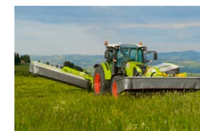
Díky kompaktnímu zavěšení v předních ramenech disponuje žací stroj na souvatí velkou světlou výškou.
