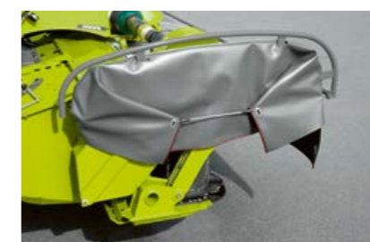
Díky nízko položenému kyvnému zavěšení kopíruje DISCO PROFIL povrch terénu nezávisle na traktoru.
