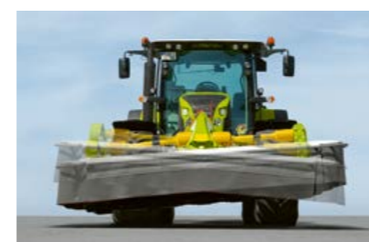
Přizpůsobení příčně ke směru jízdy díky volně se pohybuujícímu zavěšení.
