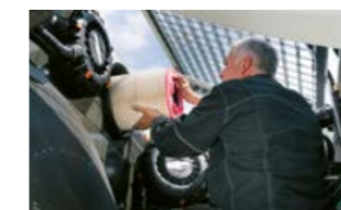
Výměna vzduchového filtru bez použití náradí
