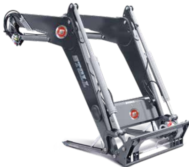
Výkyvné rameno FZ s mechanickým paralelním vedením (paralelogram): silná řešení pro profesionály od profesionálů
