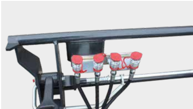
3. a 4. řídicí okruh (zde jako rychlospojka) Pro snadnou obsluhu hydraulického nářadí, např. kleští na siláž, kleští na balíky nebo stohovače na balíky.
