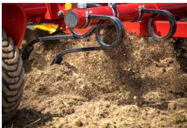
Vibrující radličky Swift zajišťují intenzivní míchání do pracovní hloubky 20 cm.
